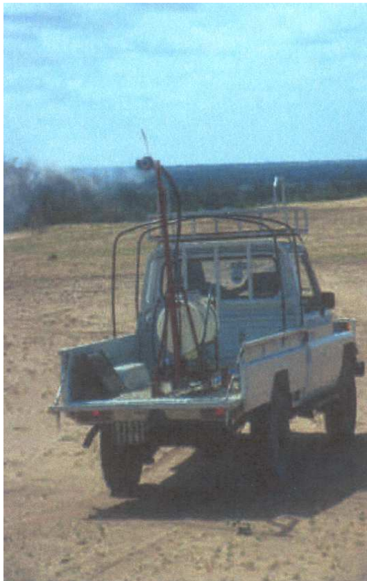
Imágenes 43.2 y 43.3. Pulverizadores “Ulvamast” montados sobre un vehículo todo terreno. El vertido del pesticida Ultra Bajo Volumen se realiza de forma perpendicular al suelo.
